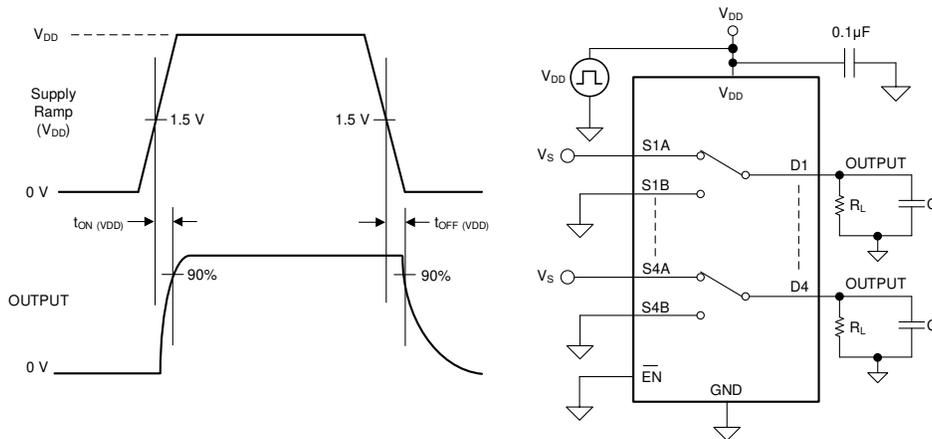
Figure 7-7. t<sub>ON</sub> (V<sub>DD</sub>) and t<sub>OFF</sub> (V<sub>DD</sub>) Time Measurement Setup
